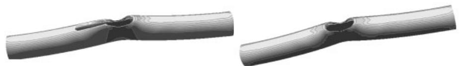
Bild 7. Verformter Zustand von Zugstäben (33,7 × 3,2 mm) mit schlüsselartigen bzw. runden Löchern nach FEM-Berechnungen im Traglastzustand
