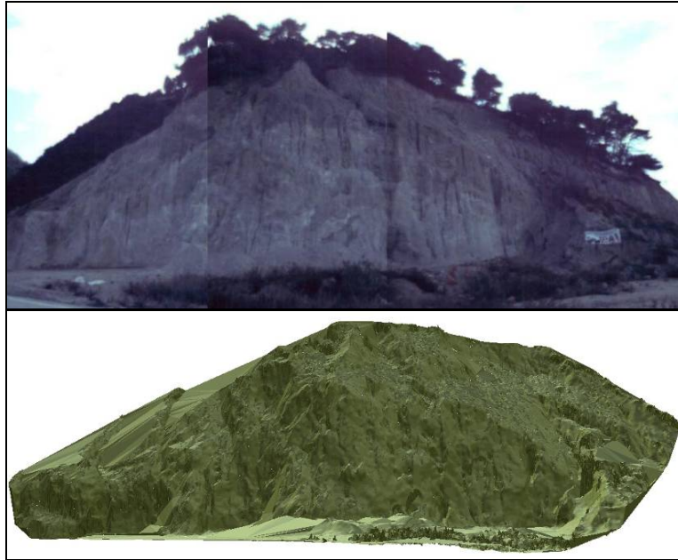
Σχήμα 8. Ένα από τα φυσικά πρανή τα οποία αποτυπώθηκαν με τη χρήση Laser Scanner και το αντίστοιχο ΨΜΕ. Για την αποτύπωση του πρανούς απαιτήθηκαν τρεις σαρώσεις.
