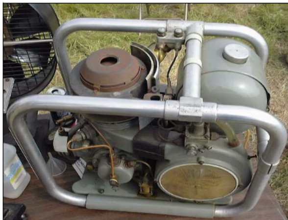
Σχ. 1-12. Philips 102C. Ηλεκτρική γεννήτρια 200W στα 220V και 50Hz (1948-1951).
