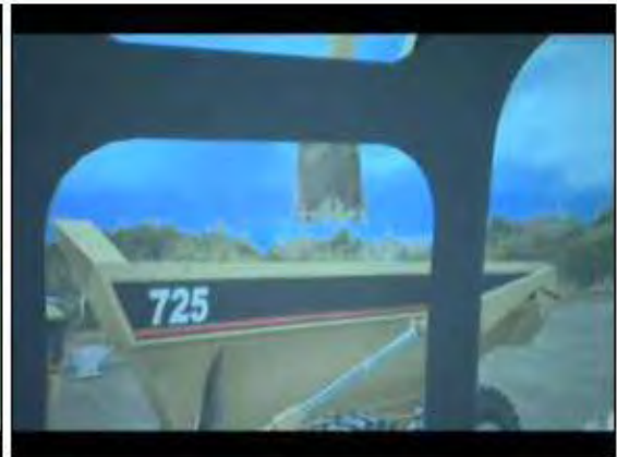
(γ) Σύστημα προσομοίωσης χειρισμών εκσκαπτικού μηχανήματος
