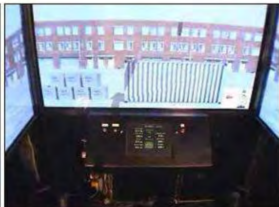
(δ) Σύστημα προσομοίωσης χειρισμών ανυψωτικού μηχανήματος
