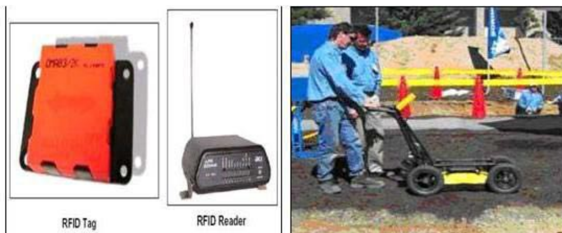
(α) Radio Frequency IDentifiers (RFID) (β) Έλεγχος υπεδάφους χωρίς εκσκαφή
