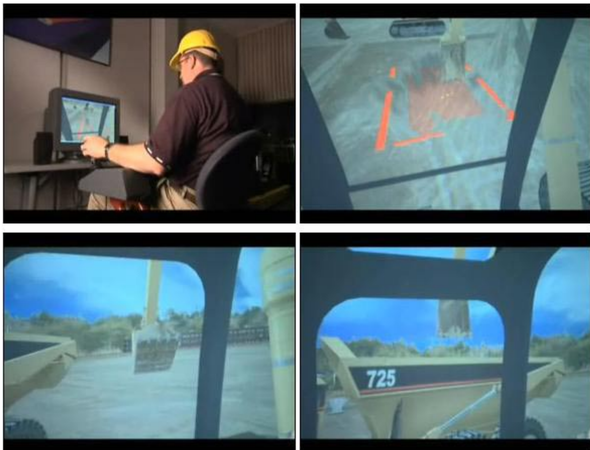
(γ) Σύστημα προσομοίωσης χειρισμών εκσκαπτικού μηχανήματος
