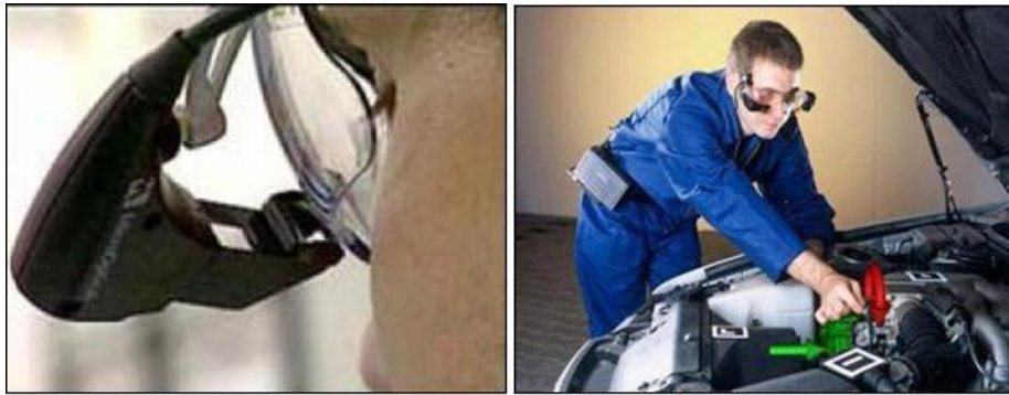
Εικόνα 35. Πρακτική χρήση συστήματος Επαυξημένης Πραγματικότητας (AR). [Με χρήση των ειδικών γυαλιών (αριστερά) είναι δυνατή η προβολή στοιχείων και οδηγιών πάνω στην προς επισκευή μηχανή είτε αυτοματοποιημένα είτε από απόσταση (δεξιά)]
