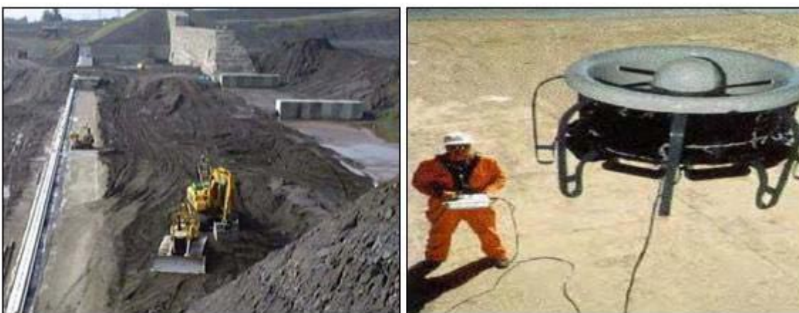
Εικόνα 30. Τηλεχειριζόμενος εκσκαφέας (αριστερά) και σύστημα ιπτάμενης κάμερας για τον έλεγχο υψηλών δομικών στοιχείων από απόσταση (δεξιά)
