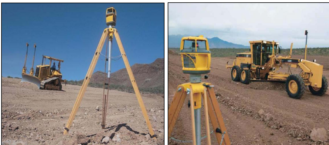
Εικόνα 28. Σύστημα AccuGrade® της Caterpillar προσαρμοσμένο σε προωθητή (αριστερά) και ισοπεδωτή (δεξιά) για την αυτόματη ρύθμιση της λεπίδας 15
