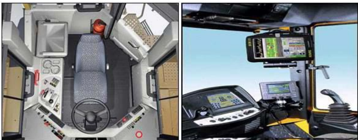
Εικόνα 22. Εργονομική καμπίνα (αριστερά) και ηλεκτρονικά βοηθήματα (δεξιά)
