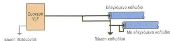
Σχήμα 6: Σχηματική διάταξη δοκιμών VLF
