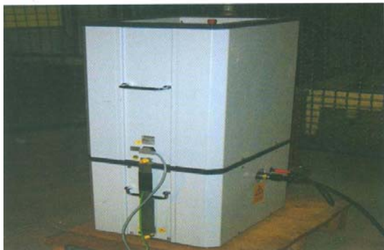
Σχήμα 5: Η συσκευή δοκιμής VLF του Εργαστήριου Υψηλών Τάσεων του Ε.Μ.Π.
