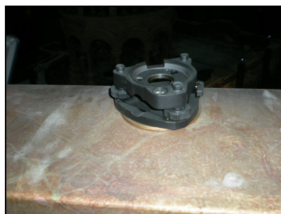
Εικόνα 2: Τρικόχλιο μόνιμα τοποθετημένο πάνω στη μεταλλική βάση
