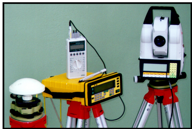
Φωτογραφία 1: Το σύστημα των αστρογεωδαιτικών παρατηρήσεων. Photograph 1: The system for the astrogeodetic observations.
