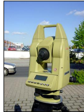
Φωτ. 9. Ο Ολοκληρωμένος Γεωδαιτικός σταθμός TC500 (Leica)
