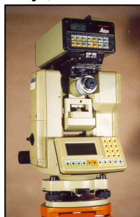
Φωτ. 18 Το αποστασιόμετρο Dior3002S προσαρμοζόμενο στο ψηφιακό θεοδόλιχο T1610
