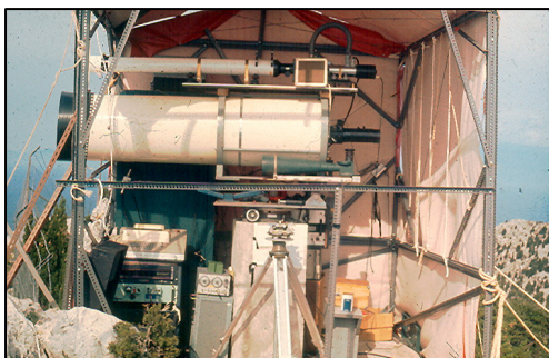
Φωτ. 12 Το σύστημα Laser, σε λειτουργία στη μέτρηση στους Οθωνούς (Αρχείο Δ.- Δ. Μπαλοδήμου)
