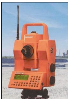
Φωτ. 37 Ο γεωδαιτικός σταθμός 600 (Aga)
