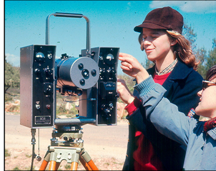
Φωτ. 9 Το γεωδίμετρο AGA 6, σε λειτουργία (Αρχείο Δ.- Δ. Μπαλοδήμου)
