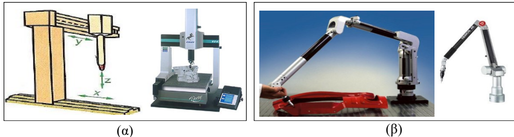
Σχήμα 1: (α) Μηχανή μέτρησης συντεταγμένων (β) Αρθρωτός βραχίονας μέτρησης συντεταγμένων
