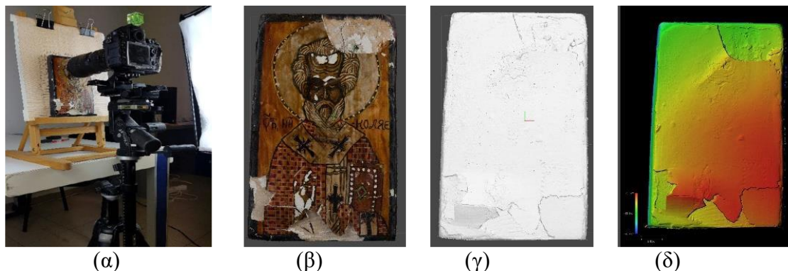
Εικόνα 6. (α) Διάταξη λήψης, (β) τριδιάστατο μοντέλο με υφή, (γ) τριδιάστατο μοντέλο χωρίς υφή, (δ) DEM
