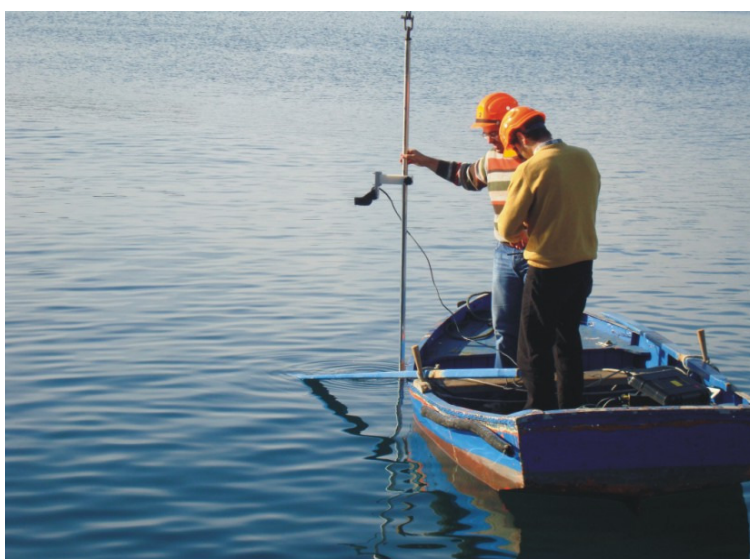
Εικόνα 3. Ειδική διάταξη βαθμονόμησης (αριστερά) και χρήση της κατά την εφαρμογή της μεθόδου του «τεχνητού βυθού» (δεξιά)
