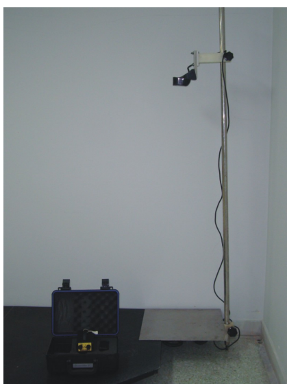
Εικόνα 3. Ειδική διάταξη βαθμονόμησης (αριστερά) και χρήση της κατά την εφαρμογή της μεθόδου του «τεχνητού βυθού» (δεξιά)
