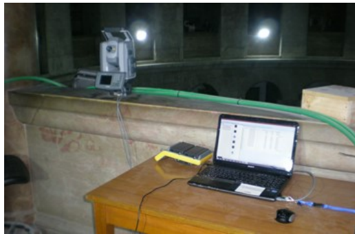
Εικόνα 2. Το σύστημα συνεχούς παρακολούθησης σε λειτουργία
