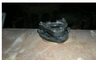
Εικόνα 1β. Τρικόχλιο μόνιμα τοποθετημένο πάνω στη μεταλλική βάση
