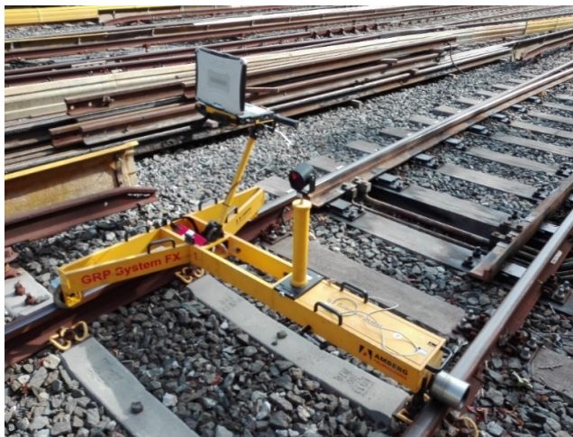
Εικόνα 5. Αποτύπωση σιδηροτροχιών με τη μέθοδο του τρόλεϋ GRP της εταιρίας Amberg Rail Technologies
