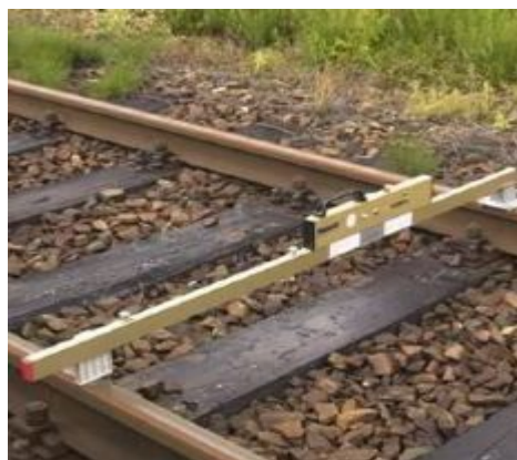
Εικόνα 2. Μετρητής εύρους γραμμής (gauge bar) και μετρητής υπερύψωσης γραμμής (το όργανο που βρίσκεται πάνω από τον μετρητή εύρους) της εταιρίας Robel [www.robel.com]
