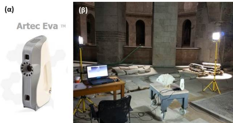
Εικόνα 5: Σαρωτής Artec Eva 3D (α), Διάταξη εξοπλισμού για την τρισδιάστατη σάρωση (β).
