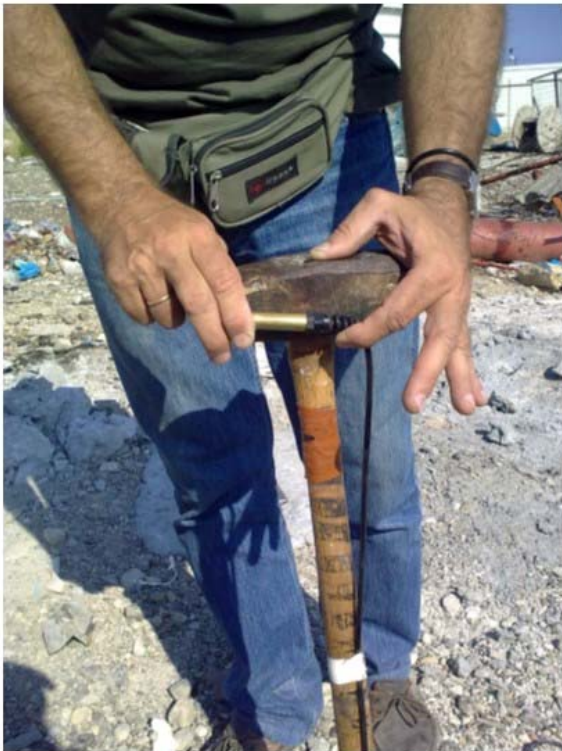
Προσάρτηση Χρονοδιακόπτη (trigger) στο σφυρί Παραγωγής σεισμικών κυμάτων P & S
