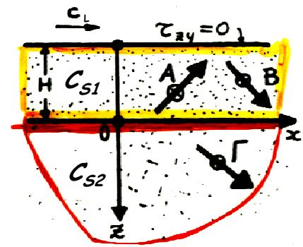
$$u_1 = \left( A e^{i r_1 k_L z} + B e^{-i r_1 k_L z} \right) e^{i(\omega t - k_L x)}$$
