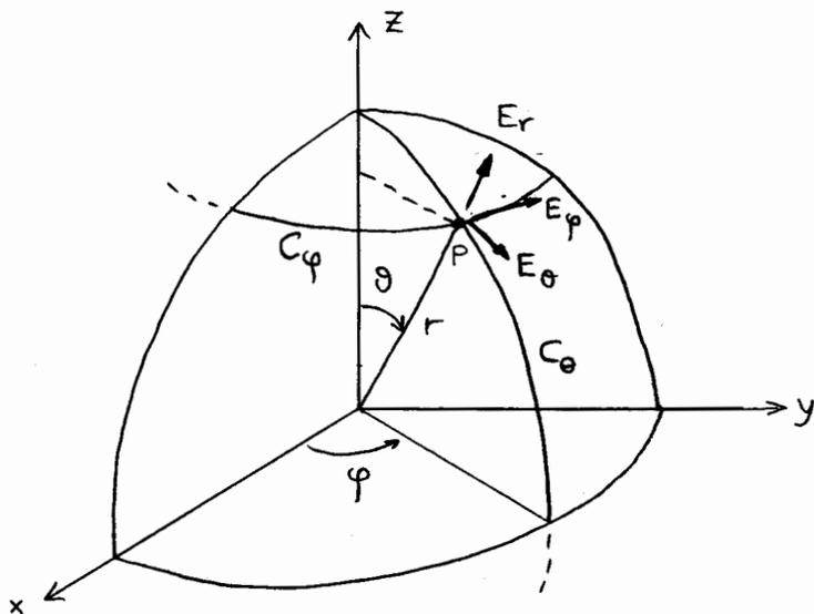
Εάν εφαρμόσουμε το αστροβίλιο του ηλεκτροστατικού πεδίου  $\oint_C \vec{E} \cdot d\vec{l} = 0$  στις κλειστές καμπύλες  $C_\phi, C_\theta$
