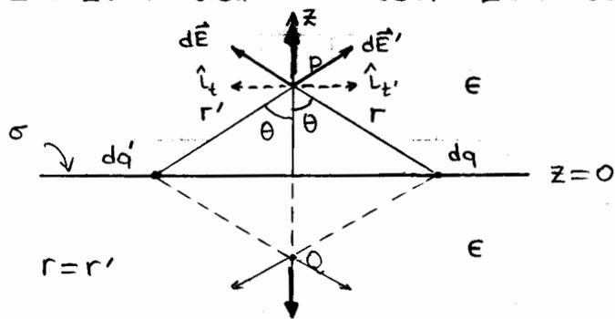
άξονα των  $z$  ο οποίος μπορεί αυθαίρετα να επιλεγεί. Έστω  $d\vec{E}$  και  $d\vec{E}'$  η συνεισφορά δύο συμμετρικών φορτίων  $dq = \sigma ds$  και  $dq' = \sigma ds$  στο σημείο  $P$ .
