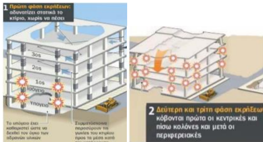
Εικόνα 1.6: 1η φάση, υποστήριξη με συρματόσχοινα, Κατεδάφιση NAT, Αθήνα, Ελλάδα 2010, 2η - 3η φάση κατεδάφισης, Κατεδάφιση NAT, Αθήνα, Ελλάδα 2010 [Νομικού Ι., Ξύδη Α. (2011)].
