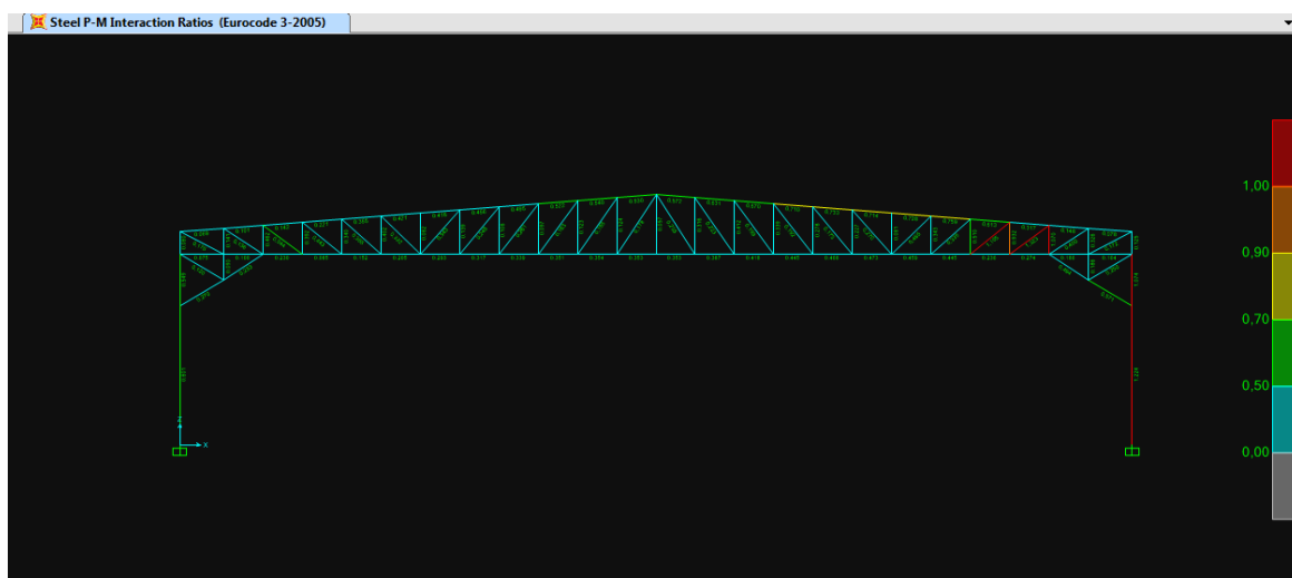
Σχήμα 3.9: Αποτελέσματα ελέγχου επάρκειας χωρικού προσομοιώματος – όψη πλαισίου Νο 3
