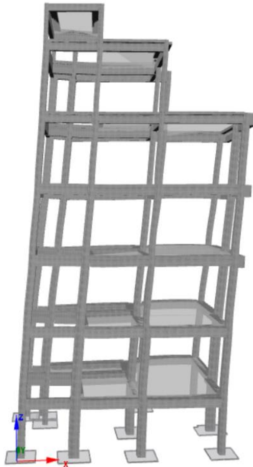
Σχήμα 3.4 Θεμελιώδης – 1 η Ιδιομορφη φορέα στην Τρίπολη-Αρκαδίας.
