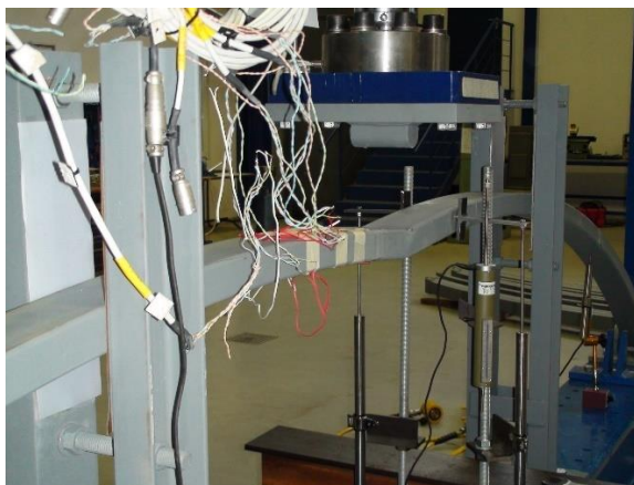
Σχήμα 9: Χαρακτηριστικά στιγμιότυπα παραμόρφωσης τόξων υπό θλίψη.
