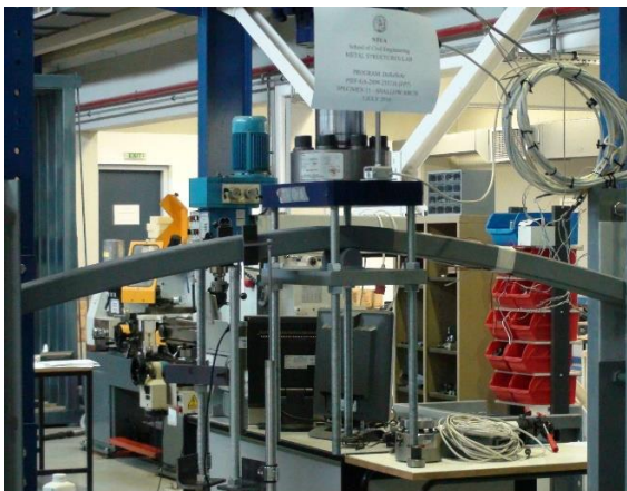
Σχήμα 11: Χαρακτηριστικά στιγμιότυπα παραμόρφωσης τόξων υπό εφελκυσμό.
