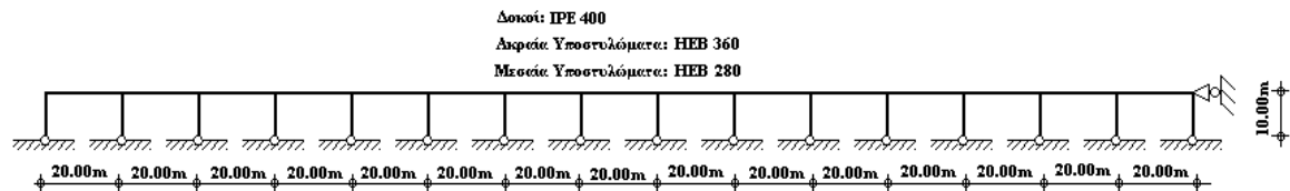
Σχήμα 3.52 Αμετάθετο πλαίσιο με δεκαπέντε φατνώματα
