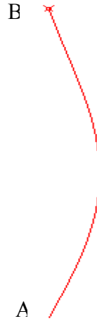
Σχήμα 3.100 Η πρώτη ιδιομορφή λυγισμού του ισοδύναμου προσομοιώματος 1γ
