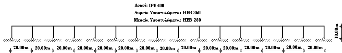
Σχήμα 3.54 Μεταθετό πλαίσιο με δεκαπέντε φατνώματα
