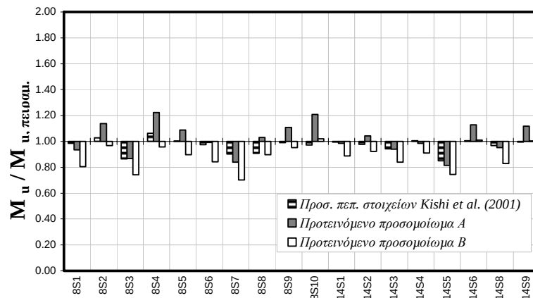
Σχήμα 7-38. Λόγος μέγιστης ροπής υπολογιστικών προσομοιωμάτων προς την μέγιστη ροπή των πειραματικών κόμβων των Azizinamini et al. (1987)
