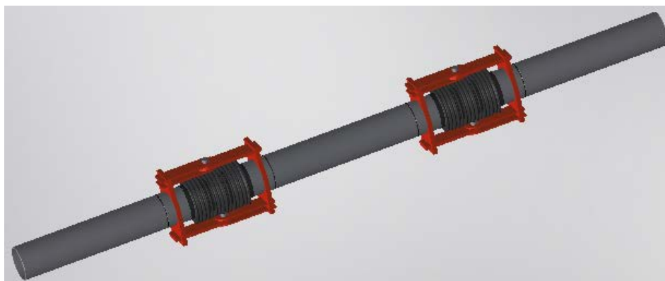
Σχήμα 3.2: Αγωγός με εύκαμπτους κόμβους
