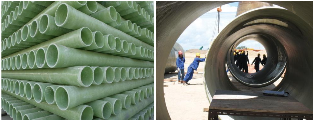
Σχήμα 4.8: Εμπορικά διαθέσιμοι αγωγοί FRP.
