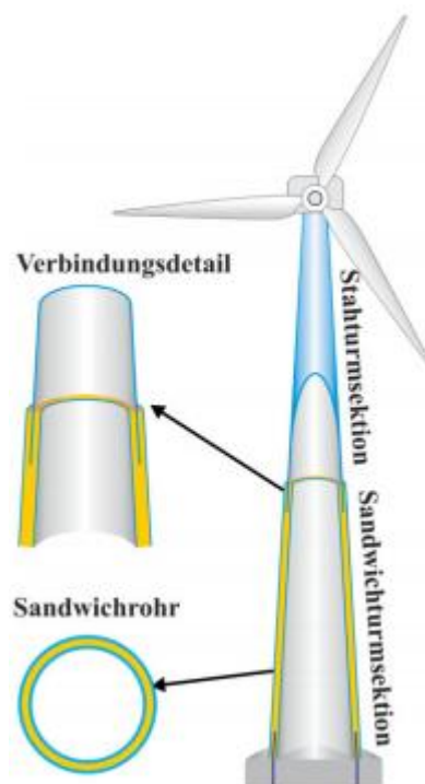
Σχήμα 3.1: Πιλοτική μέθοδος σύνδεσης υβριδικών πολώνων ανεμογεννητριών
