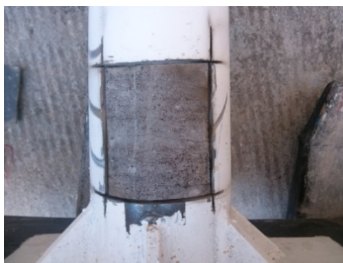
Εικόνα 5.3: Αφαίρεση τμήματος της εξωτερικής κοιλοδοκού
