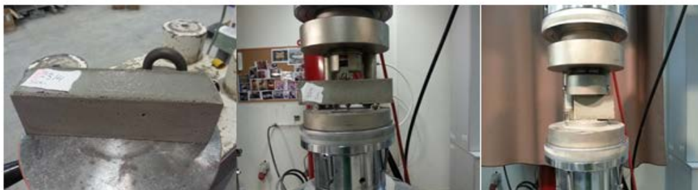
Εικόνα 2.1: (i) Δοκίμια χάλυβα μετά το πέρας δοκιμών εφελκυσμού, (ii) Δοκιμές κάμψης και θλίψης σκυροδέματος πυρήνα
