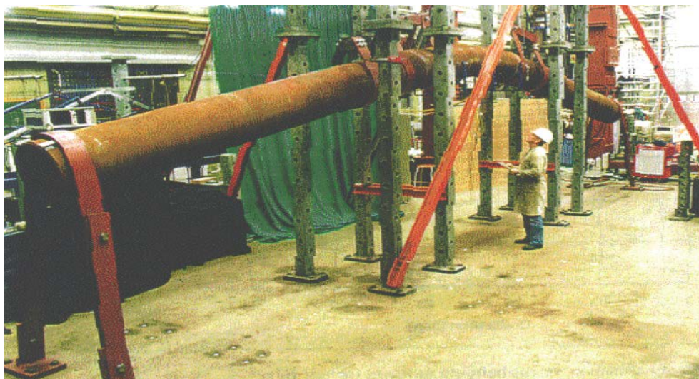
Σχήμα 3.2: Παραμορφωμένο δοκίμιο πειράματος Gresnigt and Karamanos [2]
