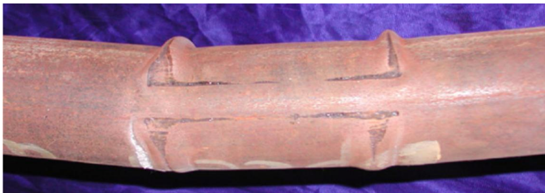
Σχήμα 4.12: Κυρίαρχη μορφή αστοχίας των υπο εξέταση δοκιμίων από τοπικό λυγισμό (Han et al., 2006)
