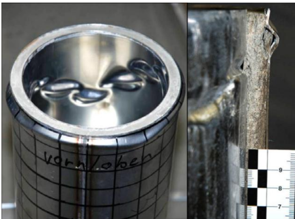
Σχήμα 4.10: Τοπικός λυγισμός με μορφή «ρυτίδωσης» εξωτερικού χαλύβδινου ελάσματος σε πειραματική δοκιμή κυλινδρικού φορέα διατομής sandwich με πυρήνα κονιάματος υπό θλίψη (Schaumann & Keindorf, 2008)
