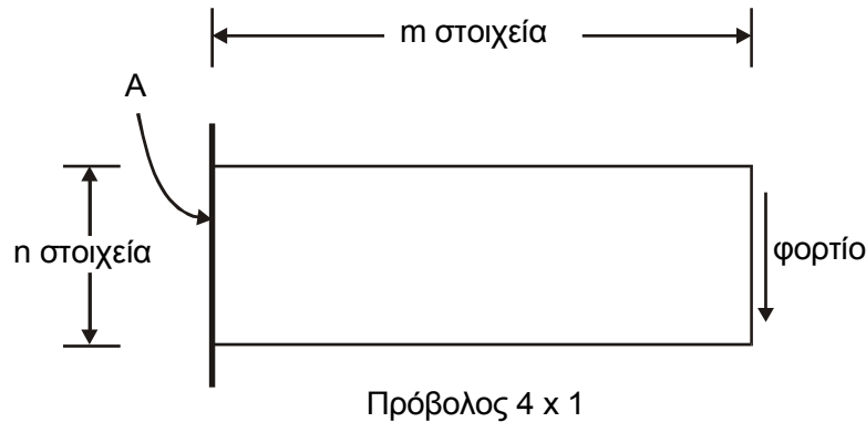
Σχήμα 14 Κατασκευή για τη σύγκριση ακρίβειας των στοιχείων LSR και CSSR
