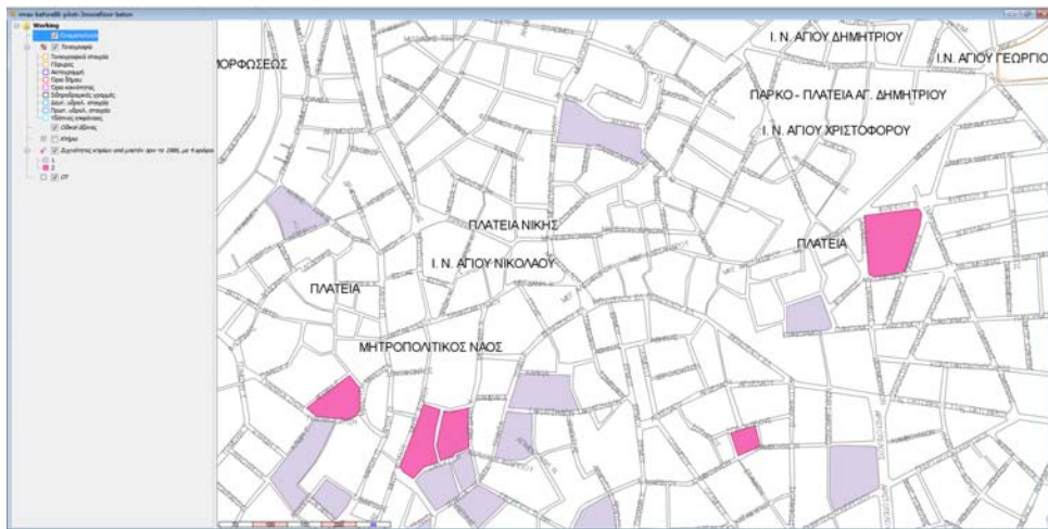
Εικόνα 13. Εντοπισμός οικοδομικών τετραγώνων με κτίρια από μετόν που κατασκευάστηκαν προ του 1985 και έχουν τουλάχιστον 4 ορόφους και πιλοτή.
