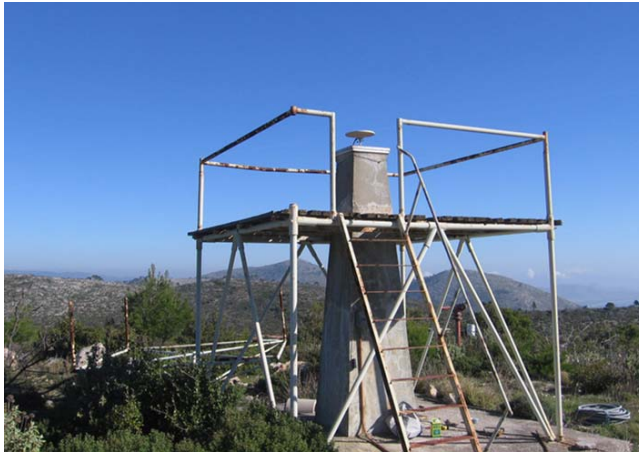
Εικόνα 10. Το βάθρο, στο Κέντρο Δορυφόρων Διονύσου του Εθνικού Μετσόβιου Πολυτεχνείου, αφιετηρία του Ελληνικού Γεωδαιτικού Συστήματος Αναφοράς του 1987.
