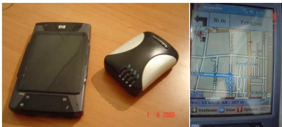
Σχήμα 1. Η διάταξη του πρώτου συστήματος πλοήγησης (αριστερά) και η οθόνη του σε λειτουργία (δεξιά)
