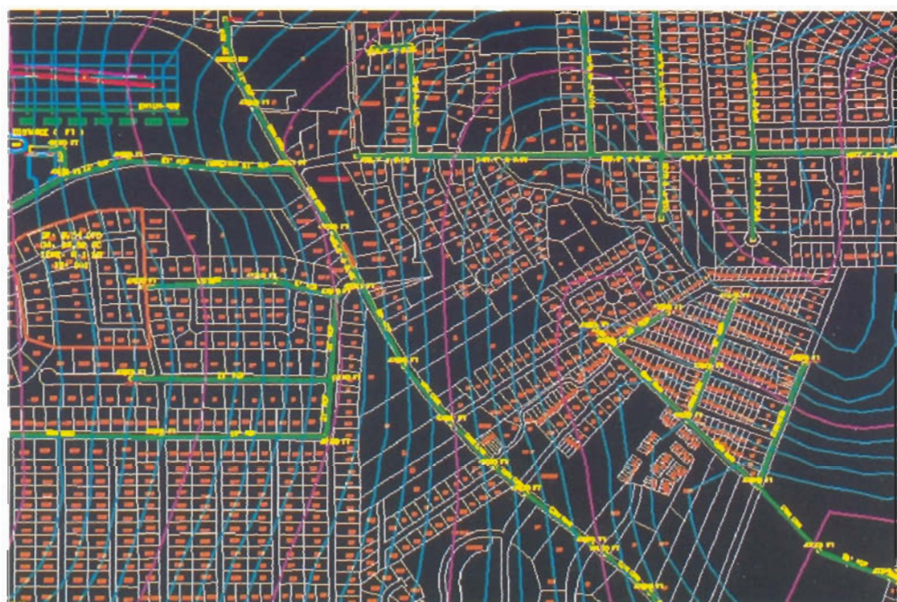
Το δίκτυο αποχέτευσης μαζί με το τοπογραφικό υπόβιοθρο όπως συνδιάζονται στο περιβάλλον ενός Συστήματος Γεωγραφικών Πληροφοριών.
