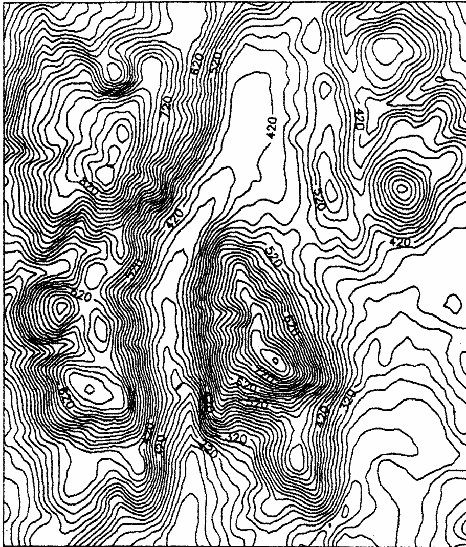
Σχήμα 11.3 Ψηφιακό μοντέλο υψομέτρων. (Συνάρτηση βάρους: w = 1/r^2 , πρόγραμμα: MMEAN , κλίμακα: 1:50.000, ισοδιάσταση: 20 m)
