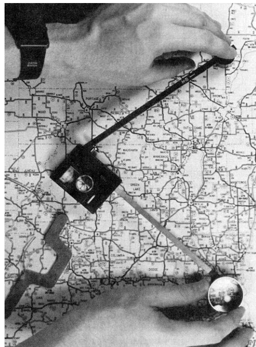
Εικόνα 5.16: Το εμβαδόμετρο, ένα αναλογικό όργανο μέτρησης του εμβαδού πολυγώνων στους χάρτες.
