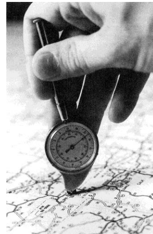
Εικόνα 5.7: Το ροδάκι, αναλογικό όργανο μέτρησης του μήκους ακανόνιστων γραμμών.
