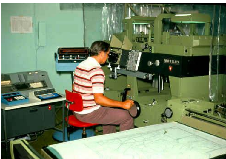
Εικόνα 5.4: Φωτο-γραμμετρικό όργανο χαρτογραφικής απόδοσης.
