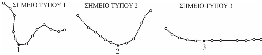
Σχήμα 5: Τρεις τύποι χαρακτηριστικών σημείων: Σημείο τύπου 1: θέση πολύ έντονης μεταβολής κλίσης, Σημείο τύπου 2: θέση έντονης μεταβολής κλίσης και Σημείο τύπου 3: θέση ευθυγράμμου τμήματος
