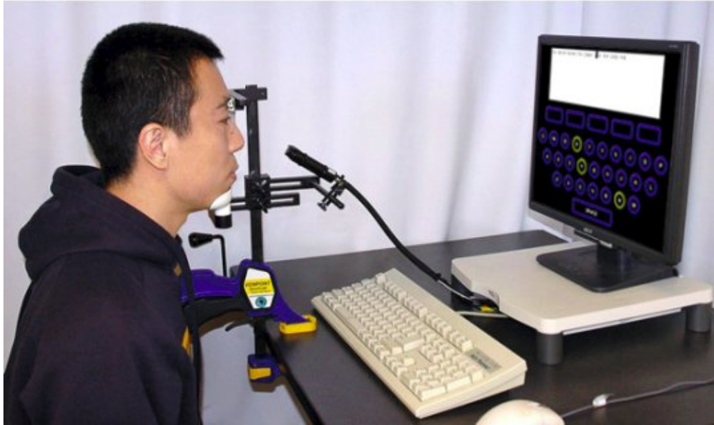
Σχήμα 3.4 : Σύστημα καταγραφής της οφθαλμικής κίνησης, όπου η θέση μεταξύ κάμερας-οφθαλμού και οπτικού συστήματος-οθόνης προβολής ερεθισμάτων παραμένει σταθερή (πηγή: http://www.yorku.ca )
