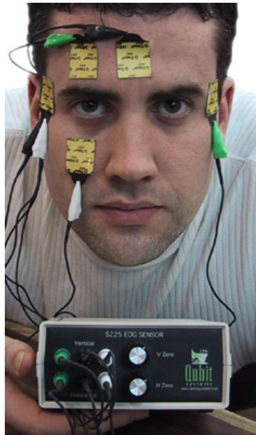
Σχήμα 3.1 : Ηλεκτρο-οφθαλμογραφία (πηγή: http://www.qubitsystems.com )
