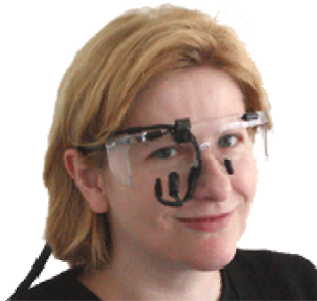
Σχήμα 3.3 : Σύστημα καταγραφής της οφθαλμικής κίνησης, προσαρμοσμένο στο κεφάλι του παρατηρητή (πηγή: http://www.arringtonresearch.com )
