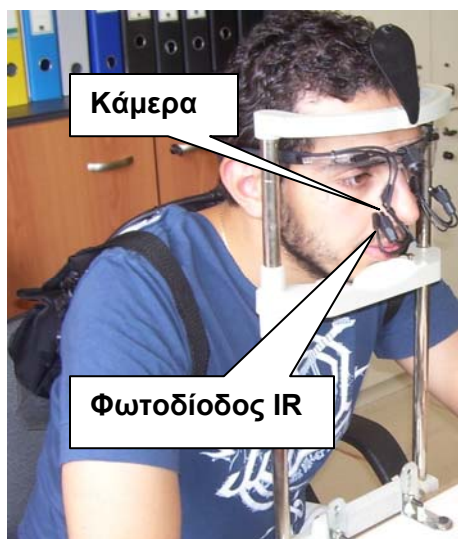
Σχήμα 3.7 : Η διάταξη της φωτοδίοδου και της κάμερας του συστήματος καταγραφής (παρατηρητής : Κασκαμπάς Νικόλαος)
