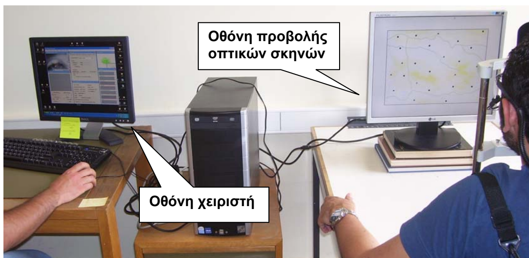
Σχήμα 3.6 : Η διάταξη των δύο οθόνων του συστήματος καταγραφής
