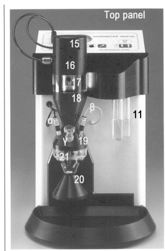
Σχήμα 3.6: (α) Ενδείξεις μονάδας ηλεκτρόλυσης 15-21.
