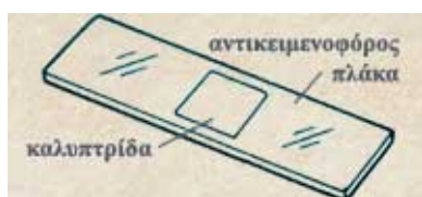
Σχήμα 12.2: Αντικειμενοφόρος πλάκα – Καλυπτρίδα.
