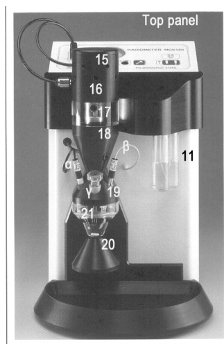
Σχήμα 8.6: (α) Ενδείξεις μονάδας ηλεκτρόλυσης 15-21.
